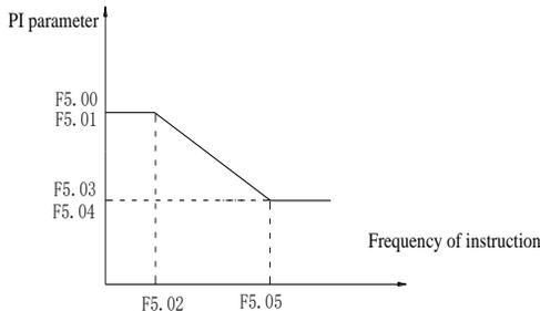
Figure 5-14:PI parameter diagram
